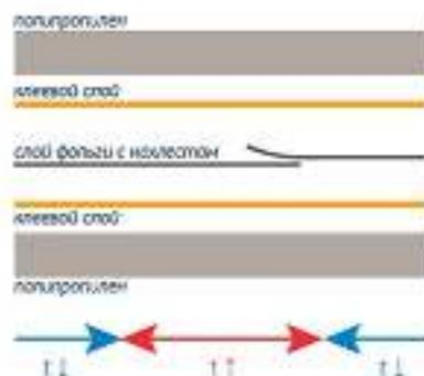
Нахлест с эластичным клеем позволяют алюминиевому слою адаптироваться к изменению диаметра трубы вследствие нагрева-охлаждения.
